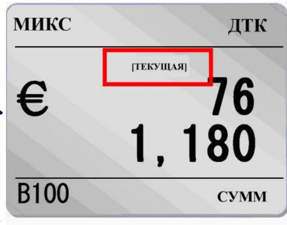
В процессе повторного подсчета купюр на экране выводится текущее значение счетчика.
